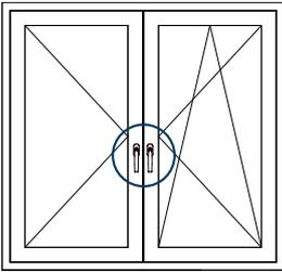
Aufgrund des fehlenden Mittelpostens verwenden wir zur leichteren Bedienung zwei Fenstergriffe. Auf Wunsch auch mit Falzhebel.
