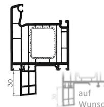
Die Transportschiene mit Doppelnutzen ist Schutz für die Fensterunterseite beim Transport und eine Möglichkeit, Aluminium-Fensterbänke anzuschrauben.
